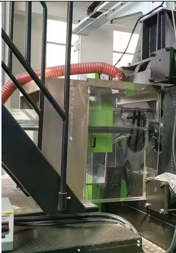
注塑、烘料废气经半密闭型集气罩收集参考图
