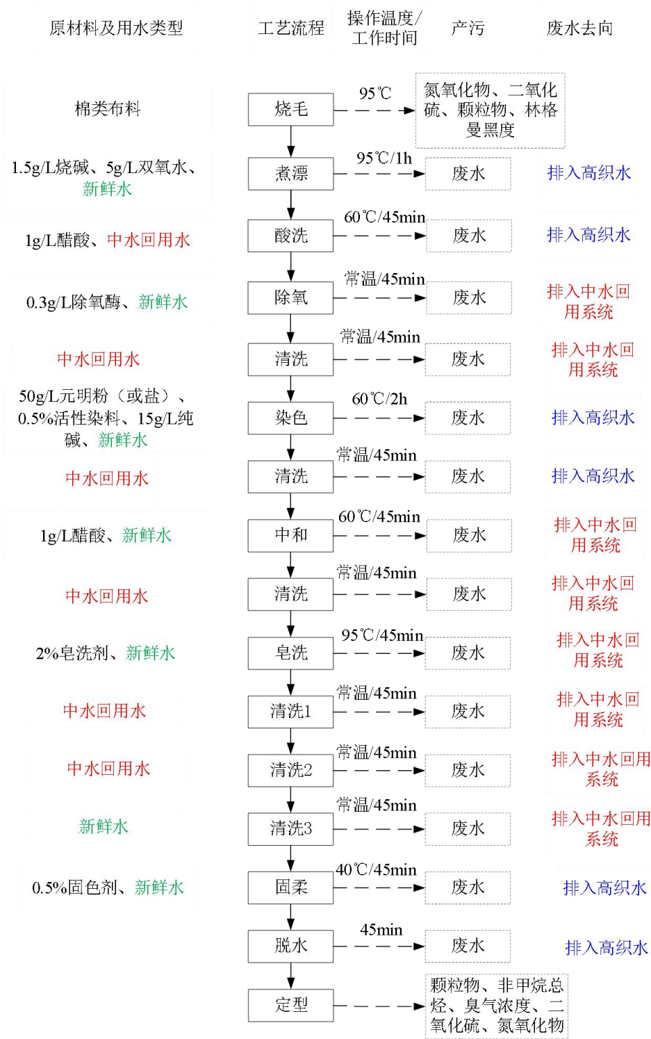
图 3.2-1 针织布生产工艺流程
