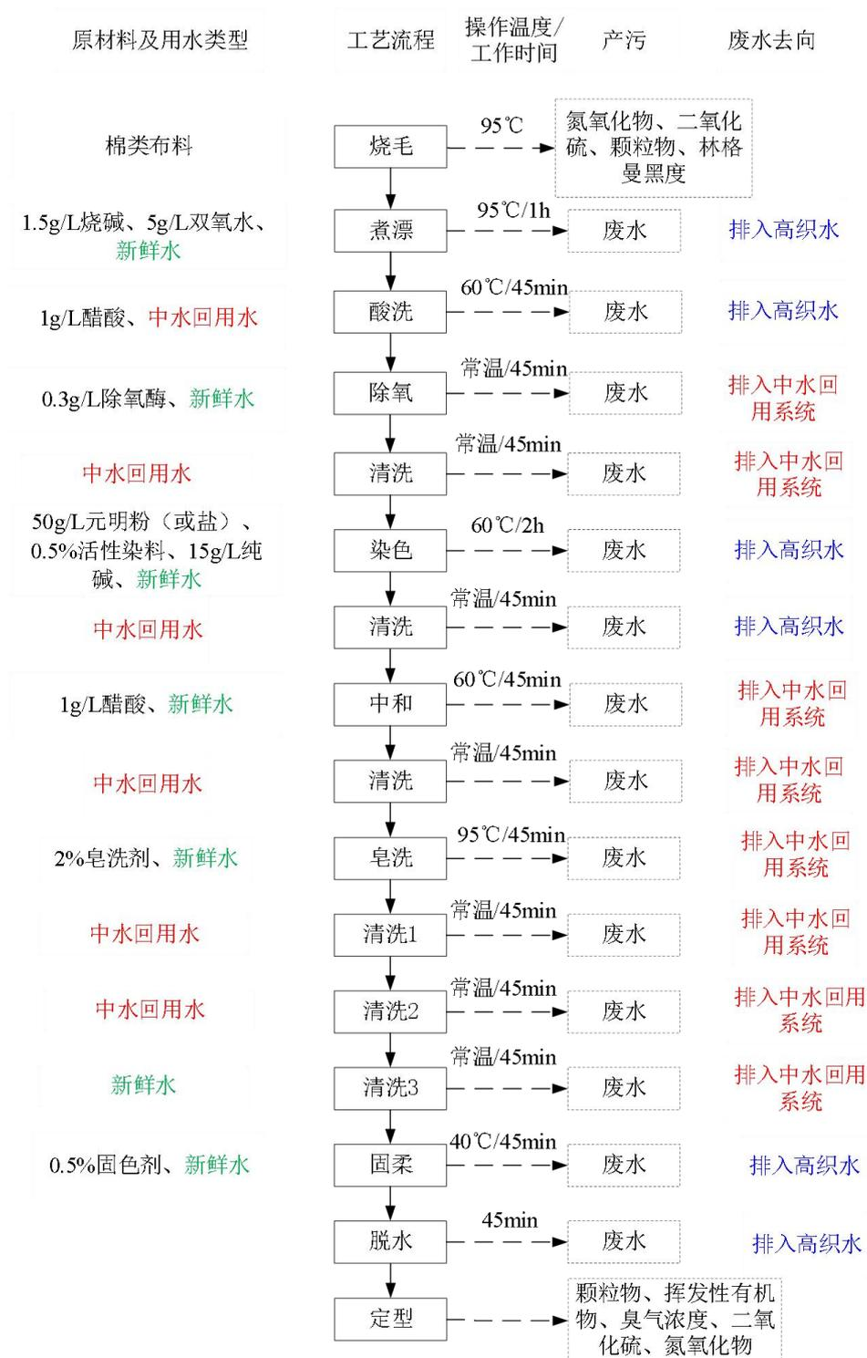
图 3.2-1 针织布生产工艺流程
