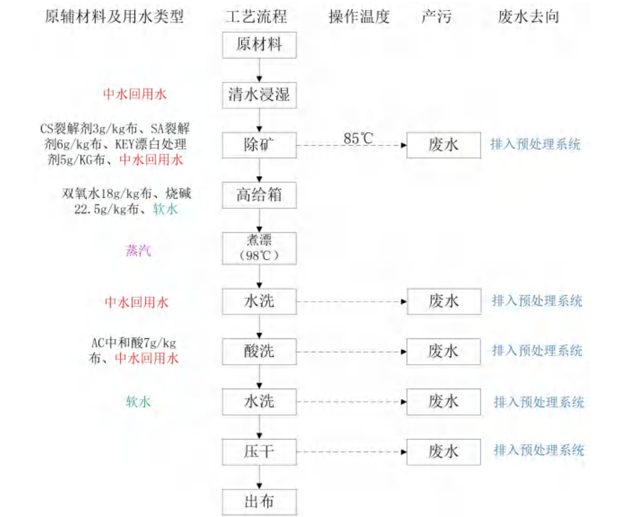
图 4.2-9 煮漂机生产工艺流程
