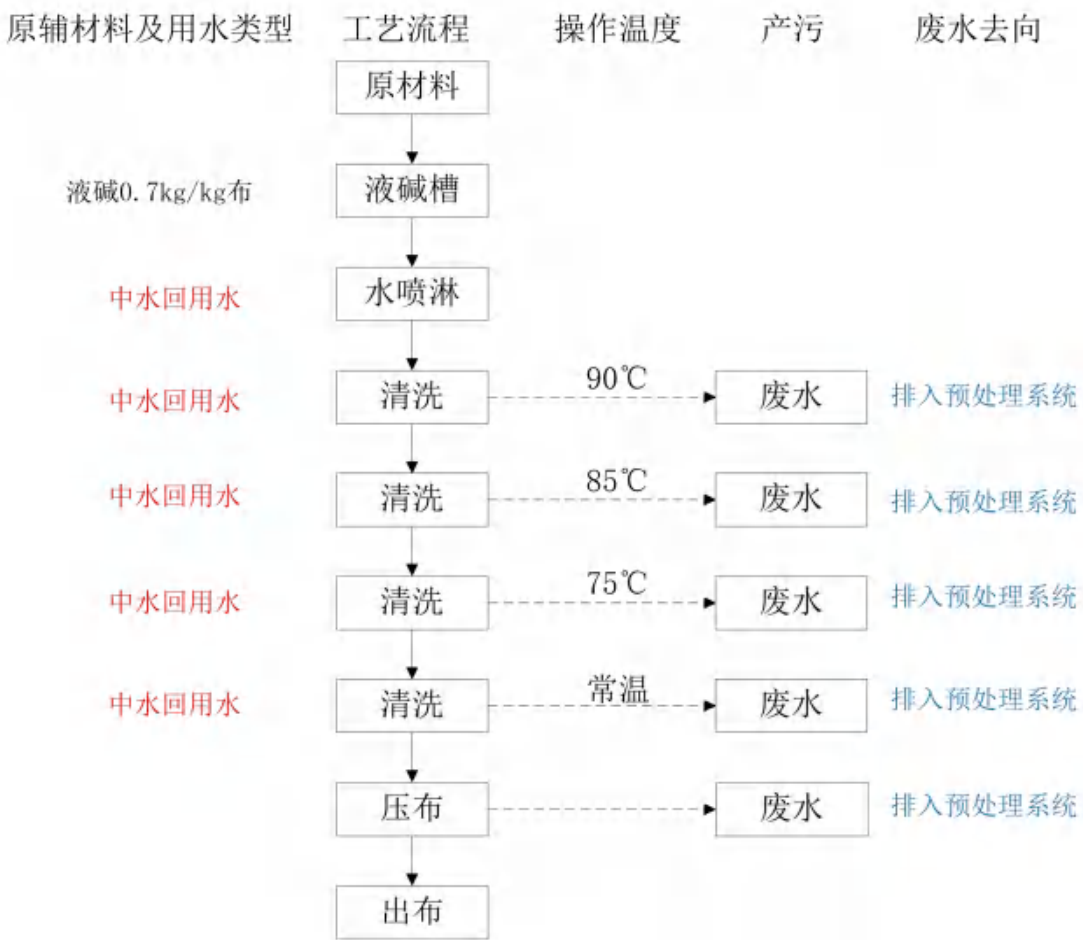
图 4.2-7 针织平幅丝光机工艺流程
