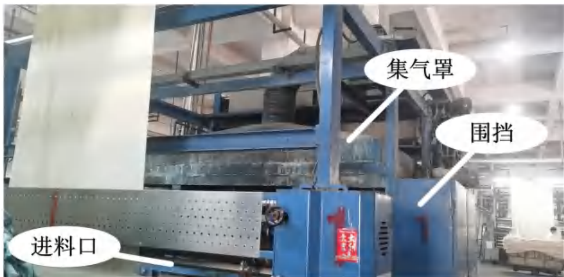
图 7.2-1 烧毛机收集示意图
