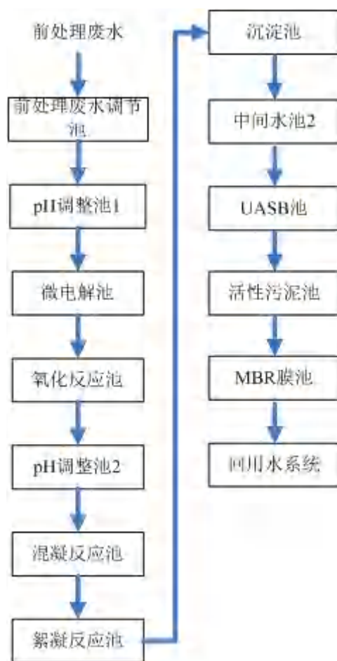
图 7.2-7 前处理废水处理工艺流程图
