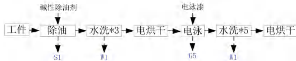
图 4.1-19 连续电泳半自动线生产工艺及产污环节
