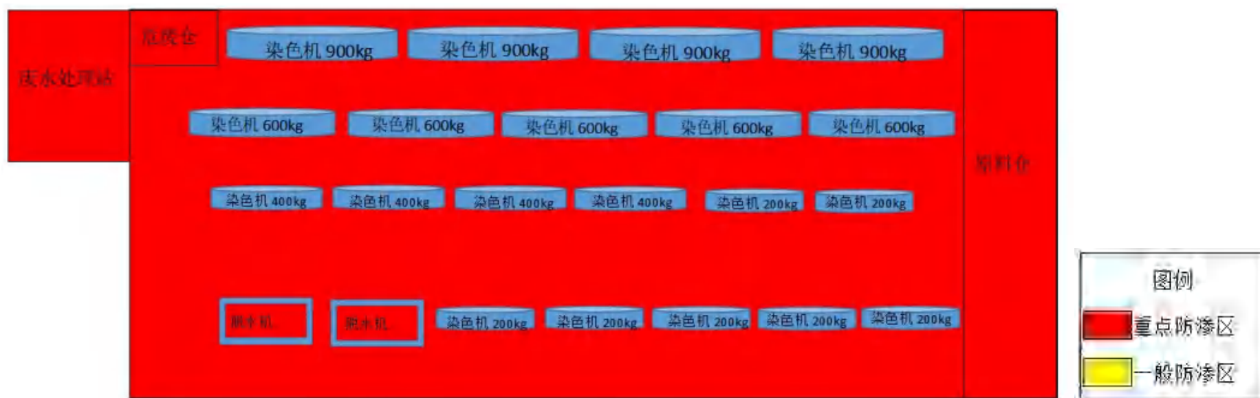
图 6.5-13 地下水厂房分区防渗图 (1F)
