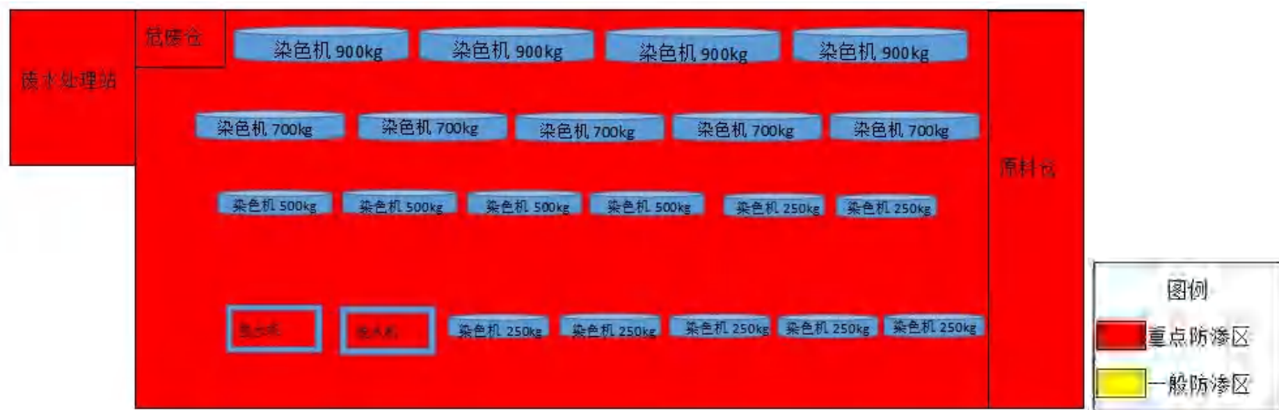
图 6.5-13 地下水厂房分区防渗图 (1F)
