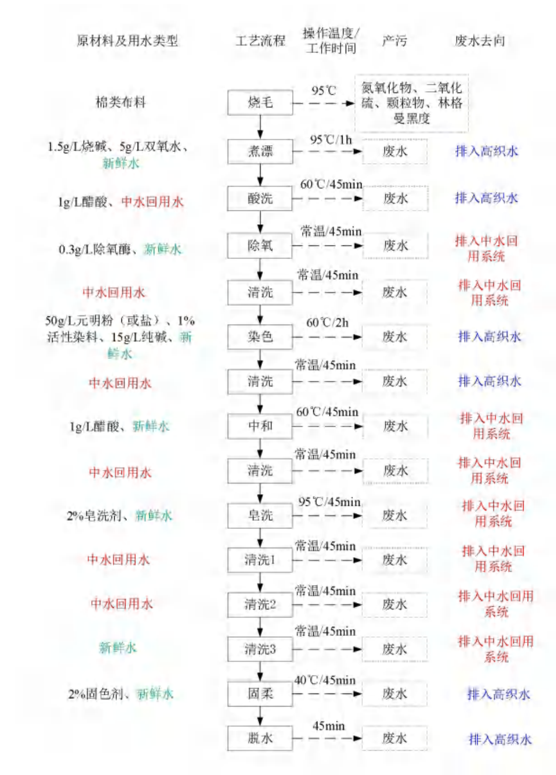
图 4.2-1 针织布生产工艺流程
