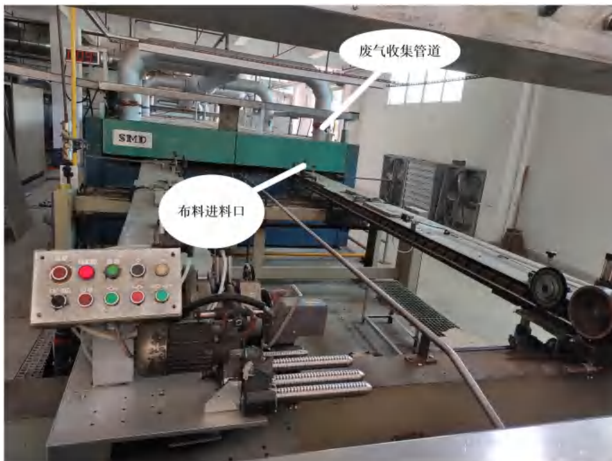
图 7.2-1 定型机废气收集示意图
