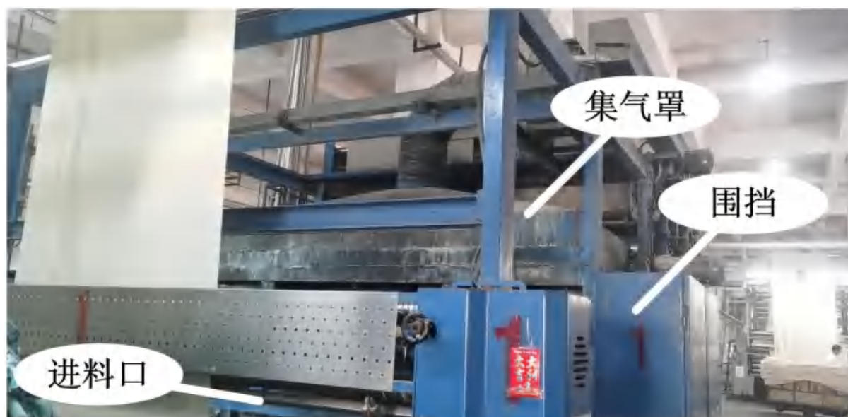
图 7.2-2 烧毛机收集示意图
