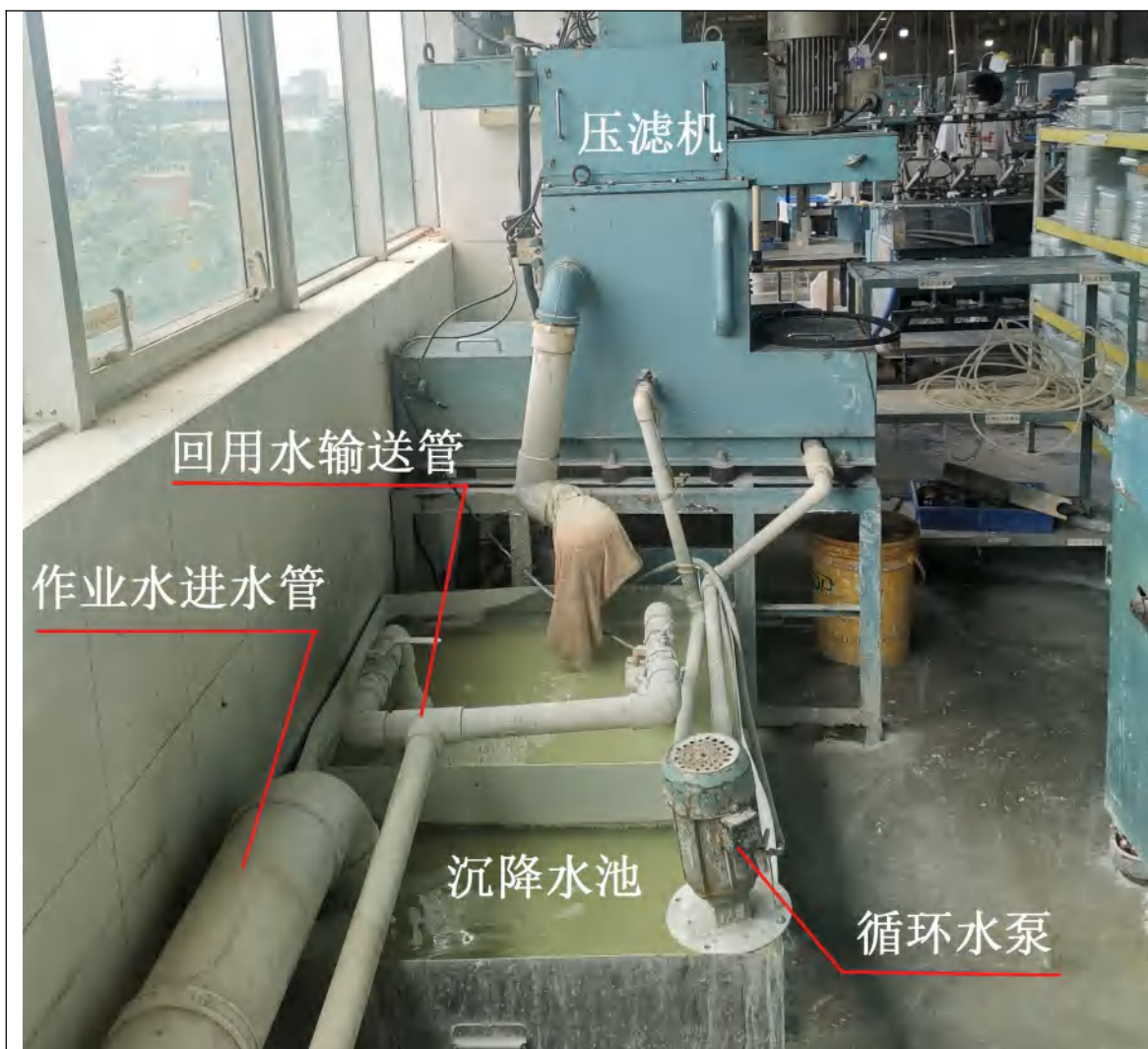
车间内设置的循环水沉降回用系统示意图
