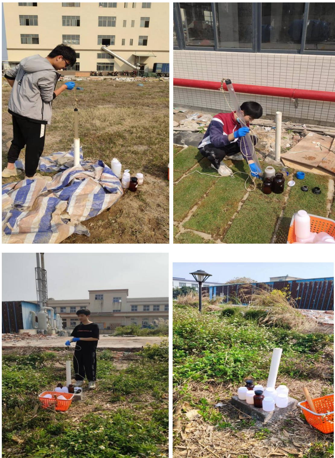
图 4.5-1 地下水采样图
