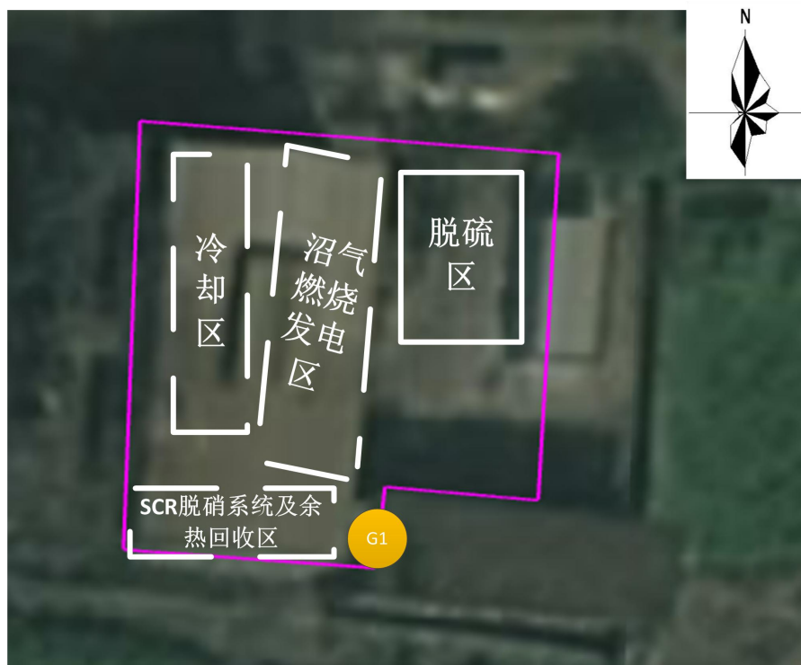
图 14 扩建部分平面布局图（G1 为排气筒）
