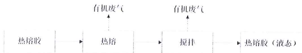
图 2：热熔胶加工生产工艺流程图
