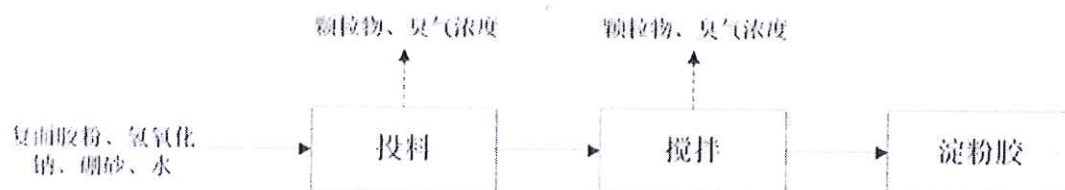
图 3：淀粉胶配制工艺流程图
