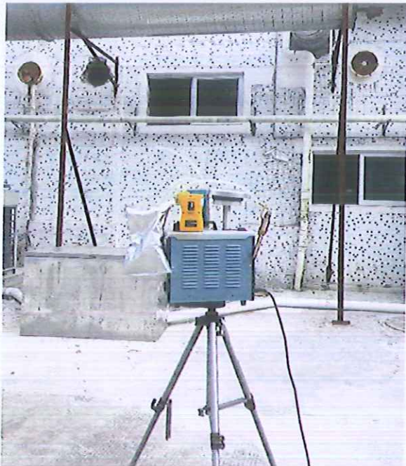
无组织废气上风向检测点
