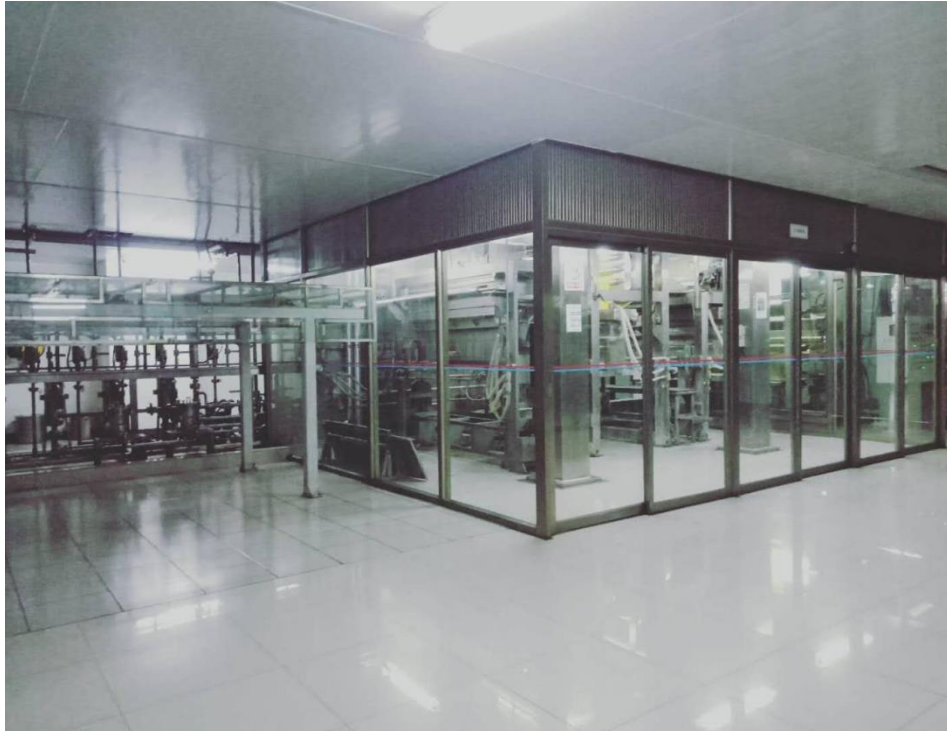
图 5 含浸区的内含浸室（每个含浸区配两个含浸室、每台上胶机配一个含浸室）
