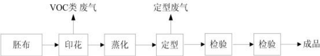
图 3.2-6 印花生产工艺流程图
