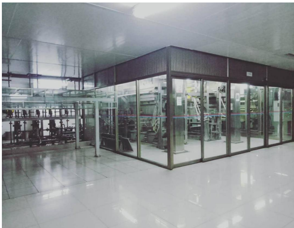
图 3 上胶区的内含浸室（每个上胶区配两个含浸室、每台上胶机配一个含浸室）
