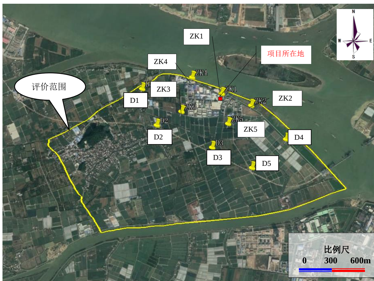
图 5.5-1 地下水监测点位布置图
