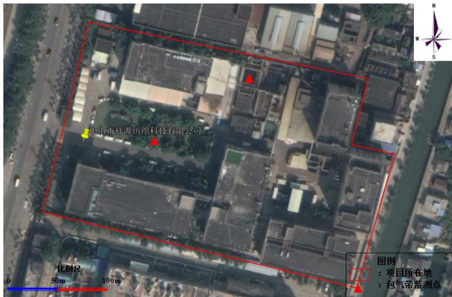
图2 包气带监测布点示意图
