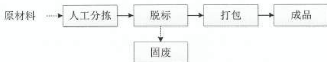
图 2.2 项目生产工艺流程图示意图
